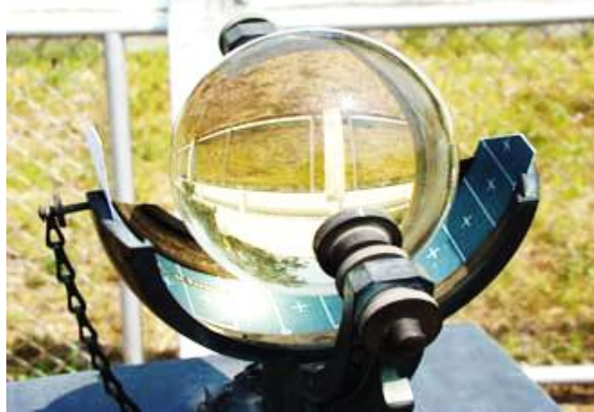
ภาพที่ 6.3 เครื่องวัดแสงแดดแบบลูกแก้ว ชนิดแคมป์เบลสโตกส์ (Campbell-Stokes Recorder) ที่มา : ศูนย์อุตุวิทยามหาวิทยาลัยขอนแก่น, 2561 : online
